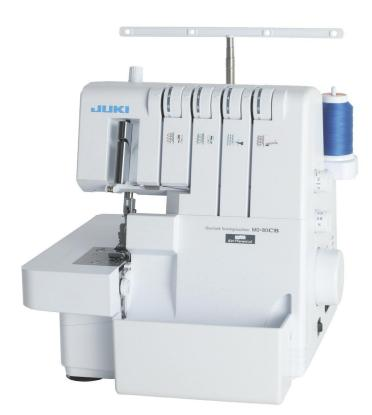
2-Aiguilles, 2/3/4 Fils avec roulotté automatique et entraînement par différentiel
