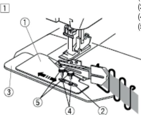
2. Alignez le biais et les aiguilles en faisant glisser le guide vers la gauche ou la droite. Serrez bien les deux vis de réglage.
