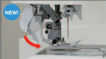
Le système de double entraînement supérieur s'installe et s'enlève très facilement. Ce système permet de faciliter l'entraînement et de travailler les matières épaisses.
