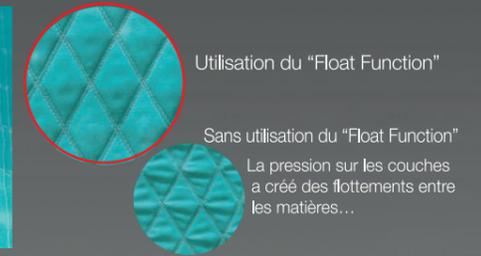
Utilisation du "Float Function" Sans utilisation du "Float Function" La pression sur les couches a créé des flottements entre les matières... Le pied presseur standard a été utilisé dans les 2 cas
